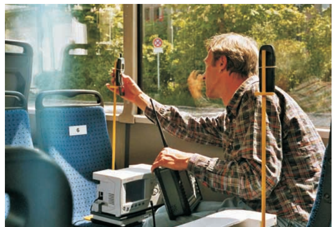
Abb. 10: Im vorderen Teil des Busses waren die Handys untergebracht und die Funkmessplätze, die die drei Handys (hier sind nur zwei zu sehen) in den gewünschten Betriebszustand dirigierten.
