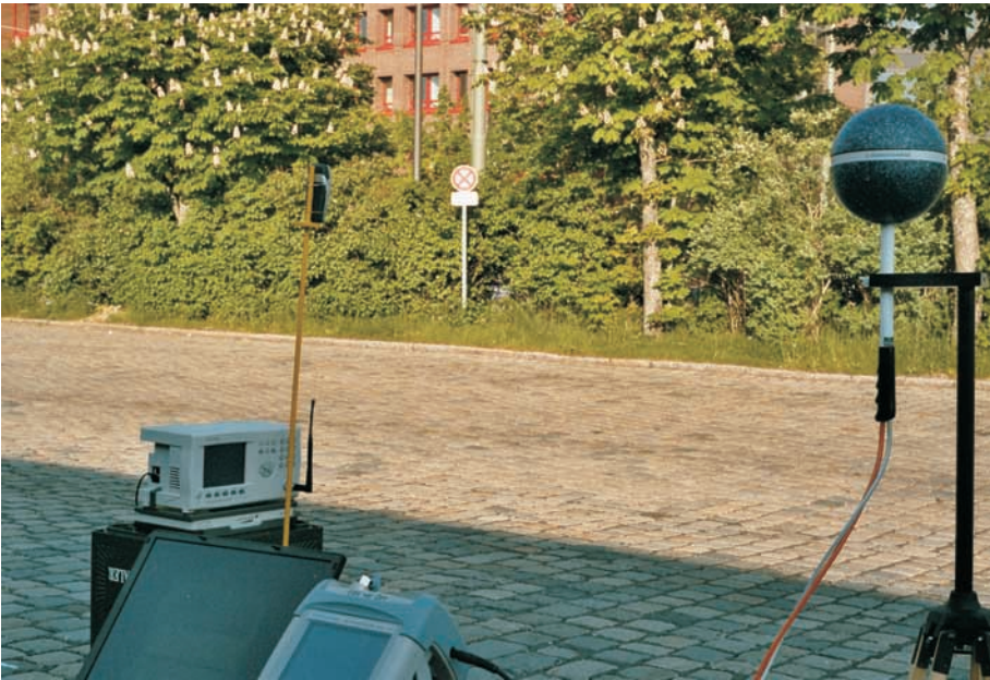
Abb. 14: Feldstärkemessung im Freien. Das Handy ist in etwa 170 cm Höhe auf der gelb lackierten Haltestange befestigt.
