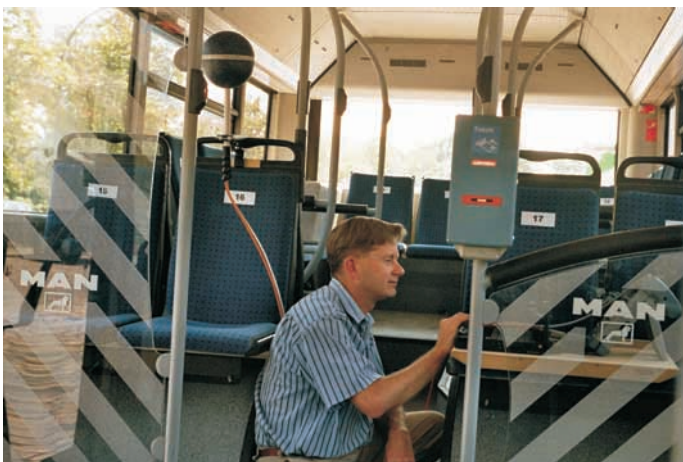
Abb. 9: Messtechniker Manfred Haider zog mit Spektrumanalysator und isotroper Messantenne (Branchenjargon: Lolly) im Bus von Sitzplatz zu Sitzplatz, um dort die Feldbelastung vor Ort zu messen.
